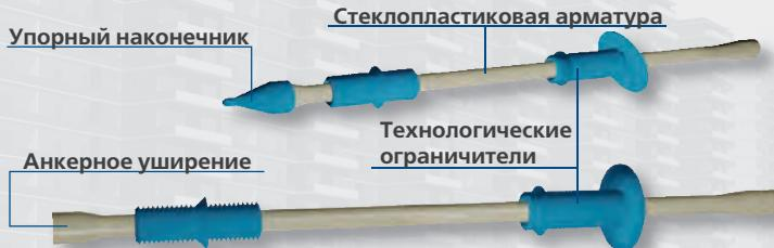
**Композиционная связь** - представляет собой высокопрочный стеклопластиковый стержень, с цилиндрическими анкерными уширениями на концах. Для облегчения установки арматуры применяются технологические ограничители.
