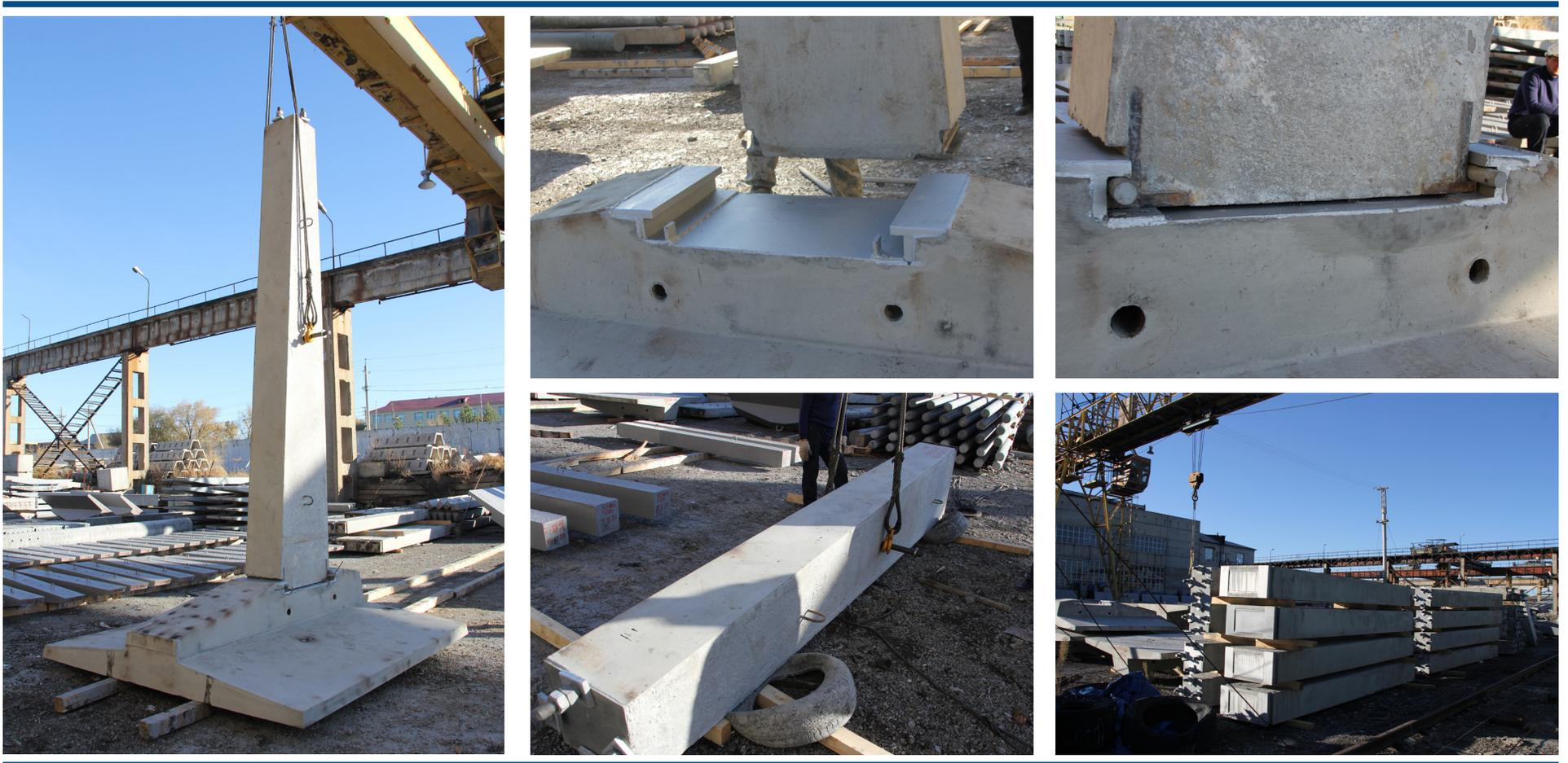
Данные фундаменты применяются в качестве подножников для свободностоящих металлических опор ВЛ 35-500 кВ. Конструкция фундамента состоит из отдельно изготавливаемых железобетонных плит и стоек которые скрепляются между собой двумя шпонками на месте установки фундамента.
