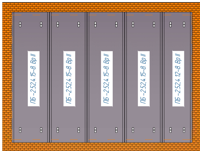
План плит перекрытия помещения
